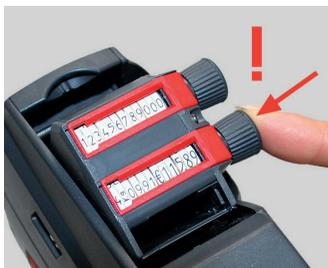
Εικόνα 8 Ώθηση και επαναφορά του κουμπιού ρύθμισης
