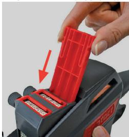
Εικόνα 24 Εισαγωγή και τοποθέτηση μόνιμης σφραγίδας
