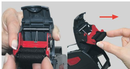
Εικόνα 13 Αφαίρεση κυλίνδρου μελανιού
